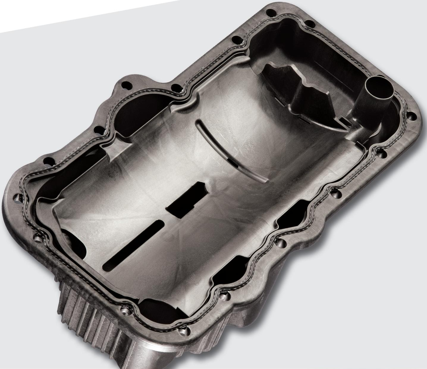
**単一部材から統合化された熱可塑性プラスチックオイルパンモジュール。** ボンネット内の軽量化は燃費効率のキー要素です。デーナの高性能熱可塑性のオイルパンモジュールは、複数の部品を一つの部材として統合化することで、ピックアップチューブ、パッフル、ガスケットのようなオイル処理関連部品を含む、従来の型抜き式のパンと比較して大きな軽量化・原価低減を実現することができます。
